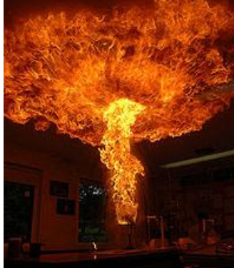
Resim 1.9: Yağ tavası yangınında suyun yanlışlıkla kullanılması
