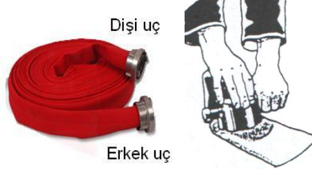
Şekil 2.3: Yangın hortumlarının Rulo istif yapılması
