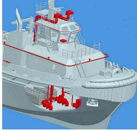
Şekil 2.6: Gemide yangın pompalarının yeri
