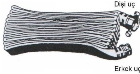
Őekil 2.1: Yangın hortumlarının katlama usul  ile toplanması
