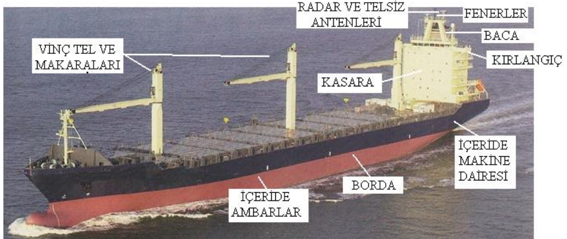
Resim 1.5: Yüksekte çalışma yapılan yerler
