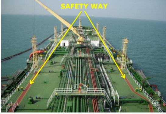
Resim 1.2: Kaymaz yol (safety way)
