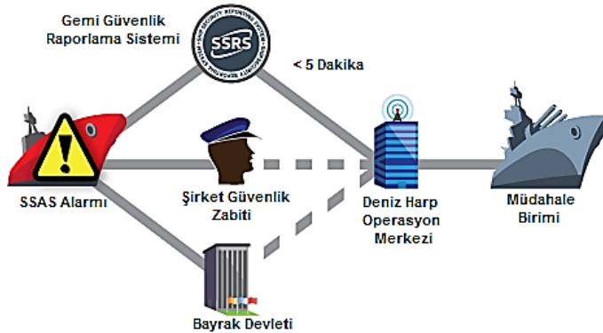
Resim 3.6: Gemi güvenlik alarm sistemi
