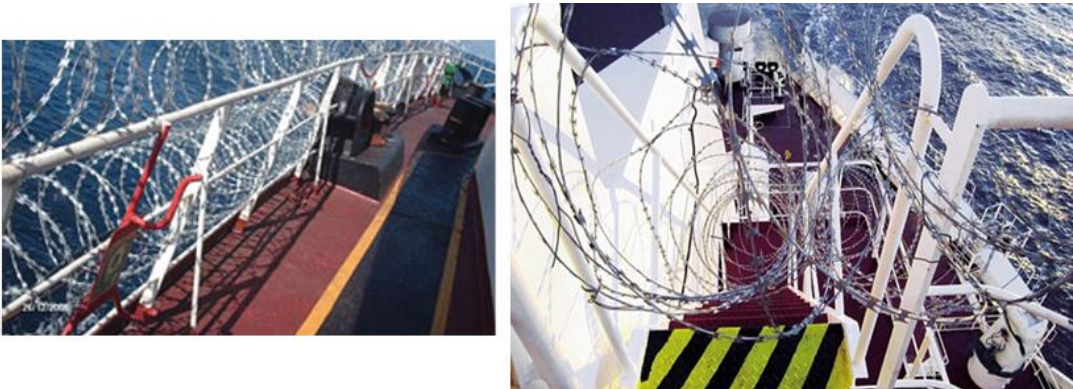
Resim 5.2: Punteller ve merdivenlerin jiletli tel ile korumaya alınması
